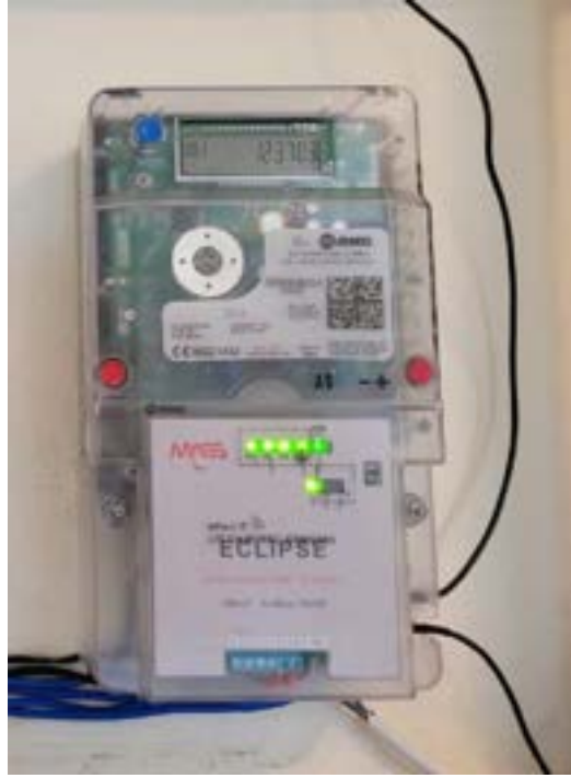
Resim 8 : Eklips NB IOT + WMbus modemi çalışma durum gösterimi
